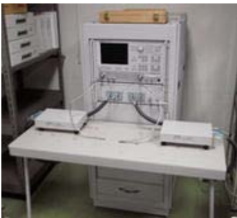
ミリ波ネットワークアナライザ (20MHz~110GHz)
